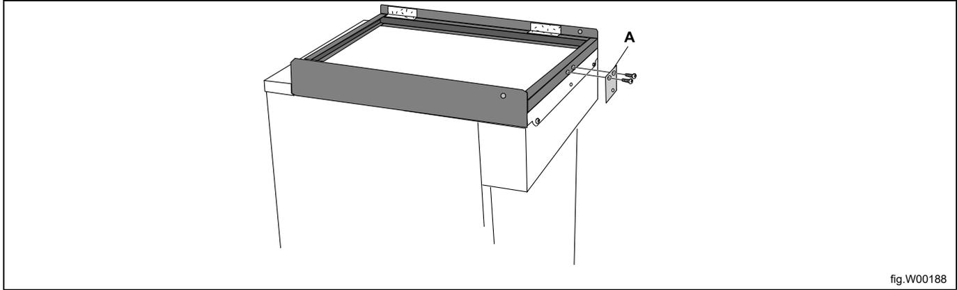
Antes de colocar la máquina que estará arriba, saque las patas al máximo para evitar que los dos aparatos entren en contacto.
